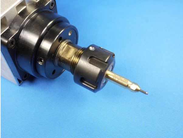
ER20-Spannzange in Fräsmotor
